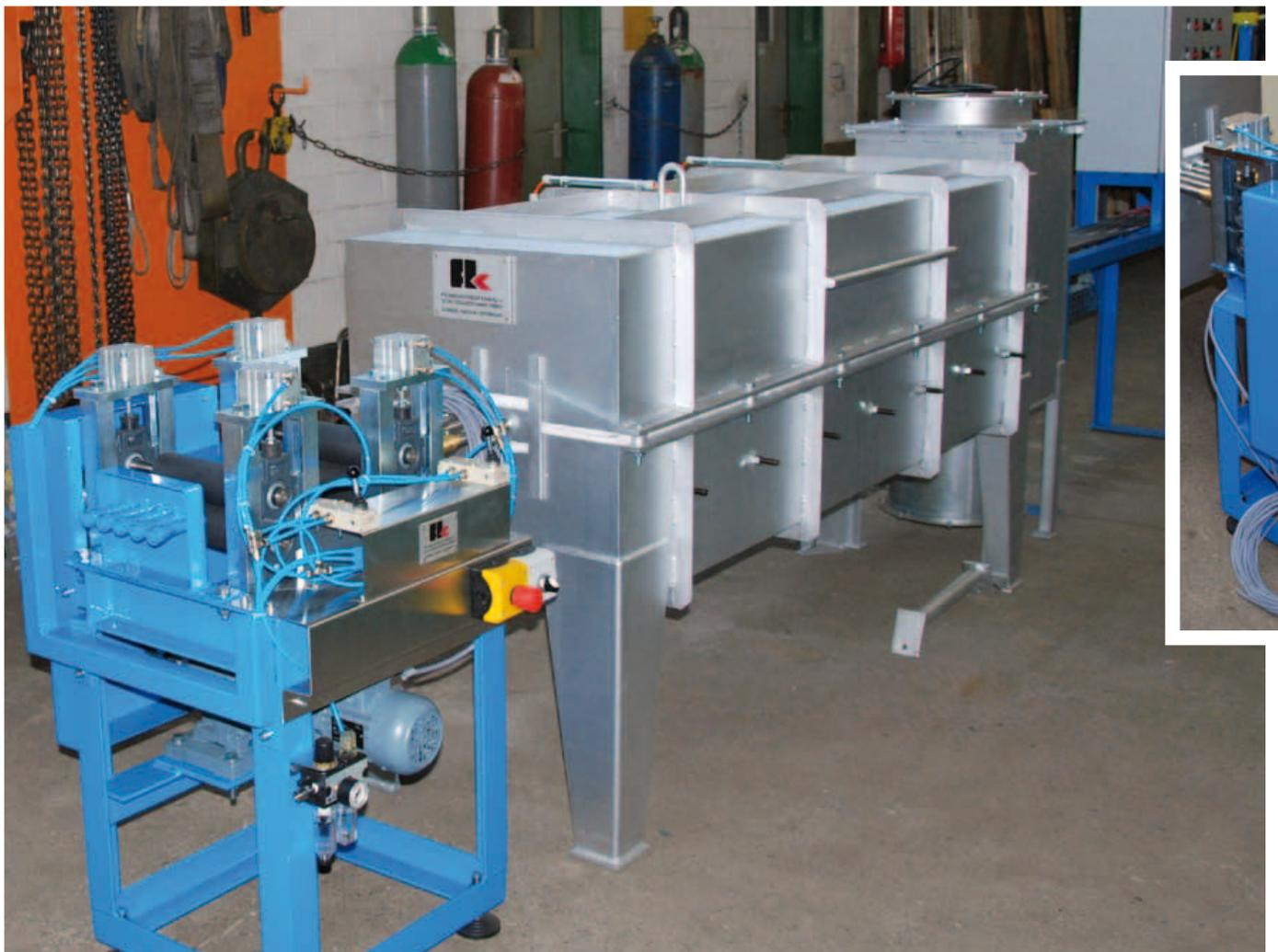
gasfüllung gehalten werden – ohne zusätzlichen Schutzgasverbrauch. Beim Produktionsstart ist ein zusätzliches Spülen nicht mehr erforderlich.
