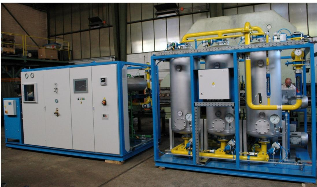
**Gesamtansicht Exogasteil und Trocknerteil einer Schutzgasanlage Typ MONOLEN**
