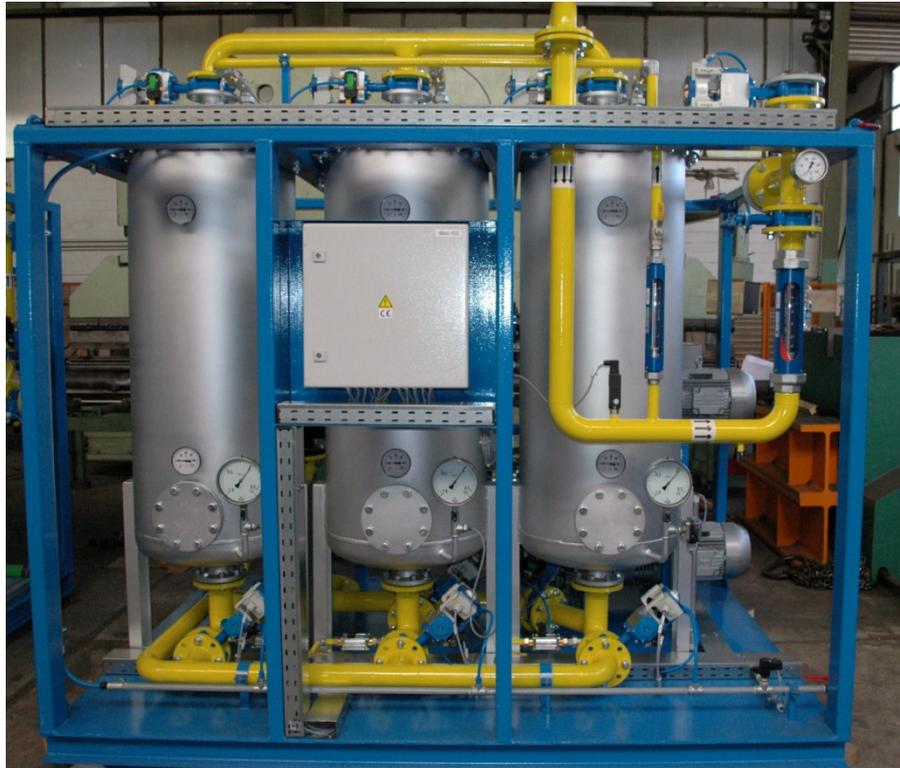
**Ansicht Vakuum generierter Adsorptionstrockner mit drei Trockenbehältern**
